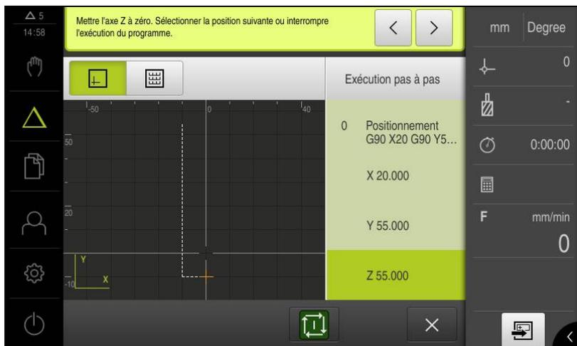
Figure 57 : Exemple – Exécution d'une séquence MDI avec un facteur d'échelle
