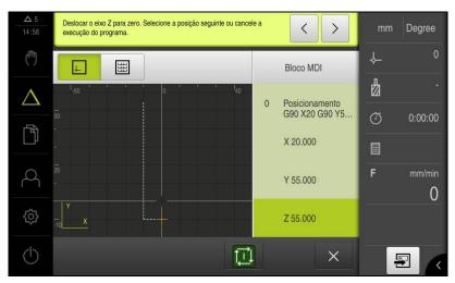
Figura 57: Exemplo - Execução de um bloco MDI com fator de escala
