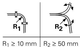
$R_1 \geq 10 \text{ mm}$
