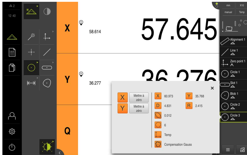
Illustration 87 : Élément Cercle avec l' Aperçu des fonctionnalités , après un enregistrement des points de mesure avec l'outil de mesure OED
