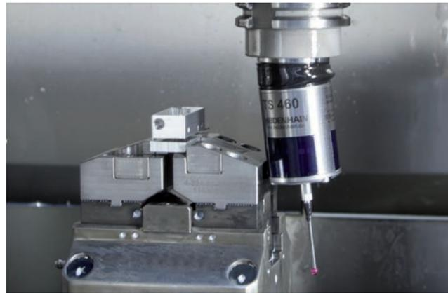
L'adattatore anticollisione protegge il sistema di tastatura da danni meccanici...
