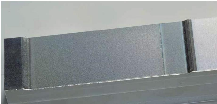
図 9:フライス加工面:ロータリエンコーダ1を使用した加工面(上側) —内挿誤差は3倍大きい
