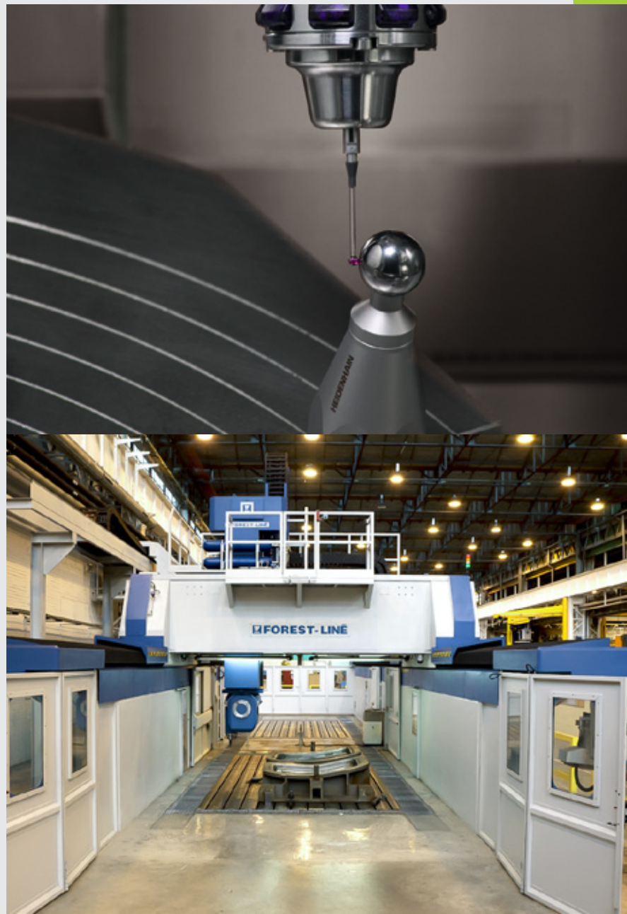
KinematicsOpt 確保即時經過長時間還是能夠再生傾斜精確度。
