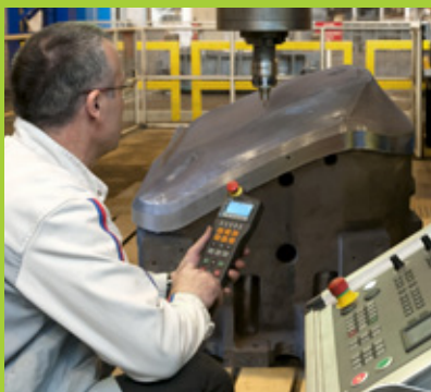
手輪疊加移動功能搭配新式無線手輪之後具有「大縱橫度」。
