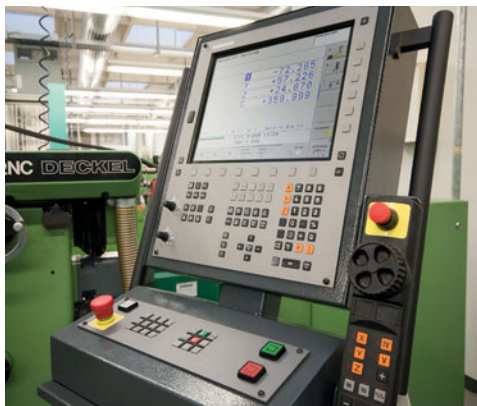
Müller Modell- und Formenbau公司 用iTNC 530加工复杂的汽车塑料件的注塑模—详见第12页
