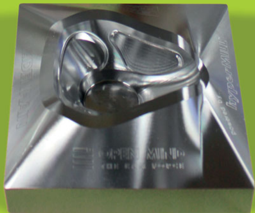
研讨会期间，用iTNC 530 HSCI数控系统加工了一个防毒面具模具。难点在材料本身：耐腐蚀塑料模具钢1.2083。
