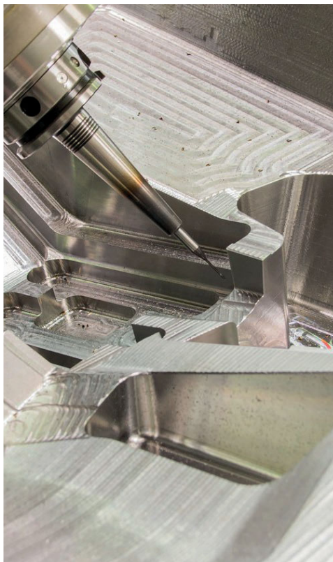
Müller Modell- und Formenbau公司 用iTNC 530加工复杂的汽车塑料件的注塑模—详见第12页
