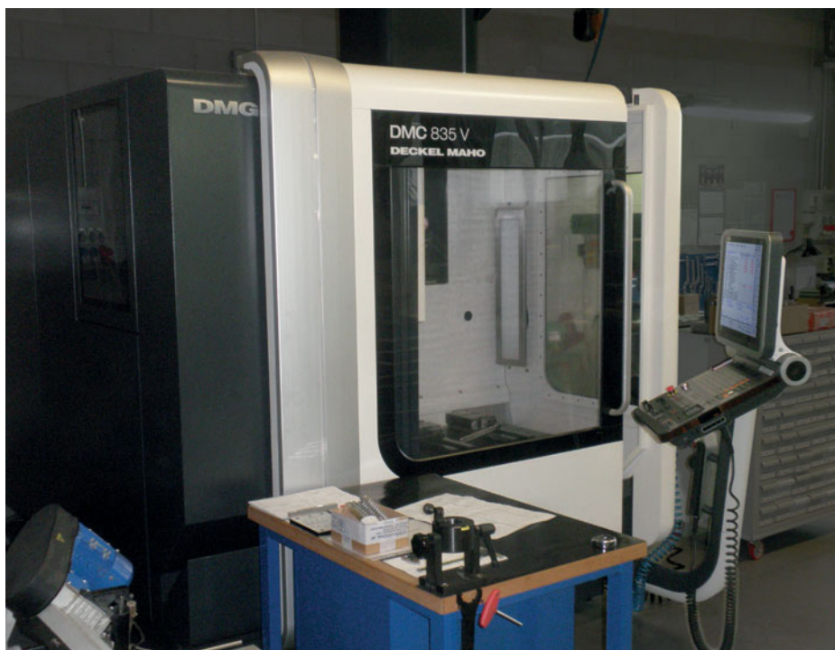
NC程序直接在TNC数控系统上编程，确保灵活和快速地上车削、钻孔和铣削循环加工部件。
