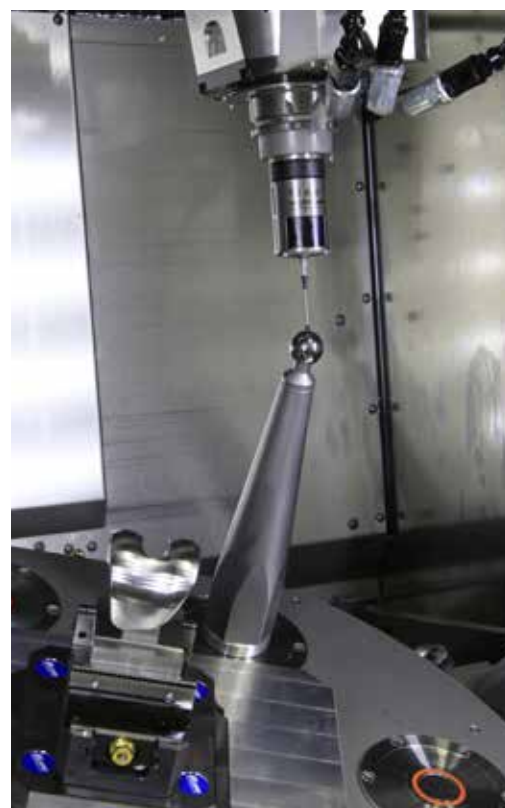
用3-D ToolComp和探测循环444提高测量精度。
