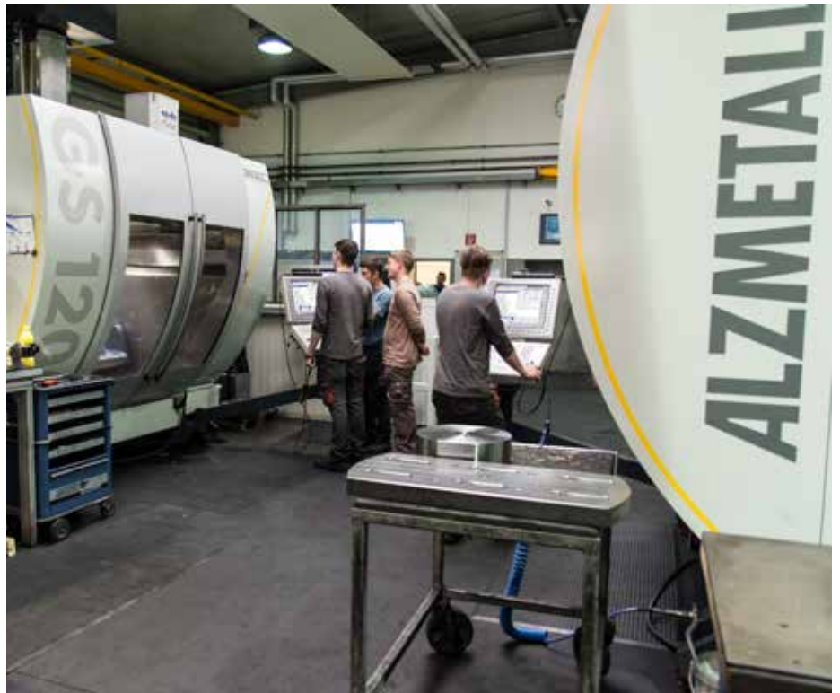
“我们在这里看到车削与铣削的完美结合。” 两台配海德汉TNC 640的全新Alzmetall GS 1200/5 FDT加工中心。
