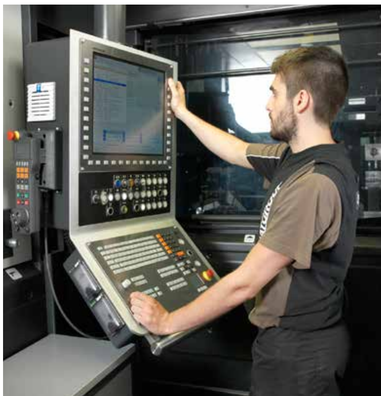
加工过程中，机床操作人员可通过TNC数控系统进行人为干预。
