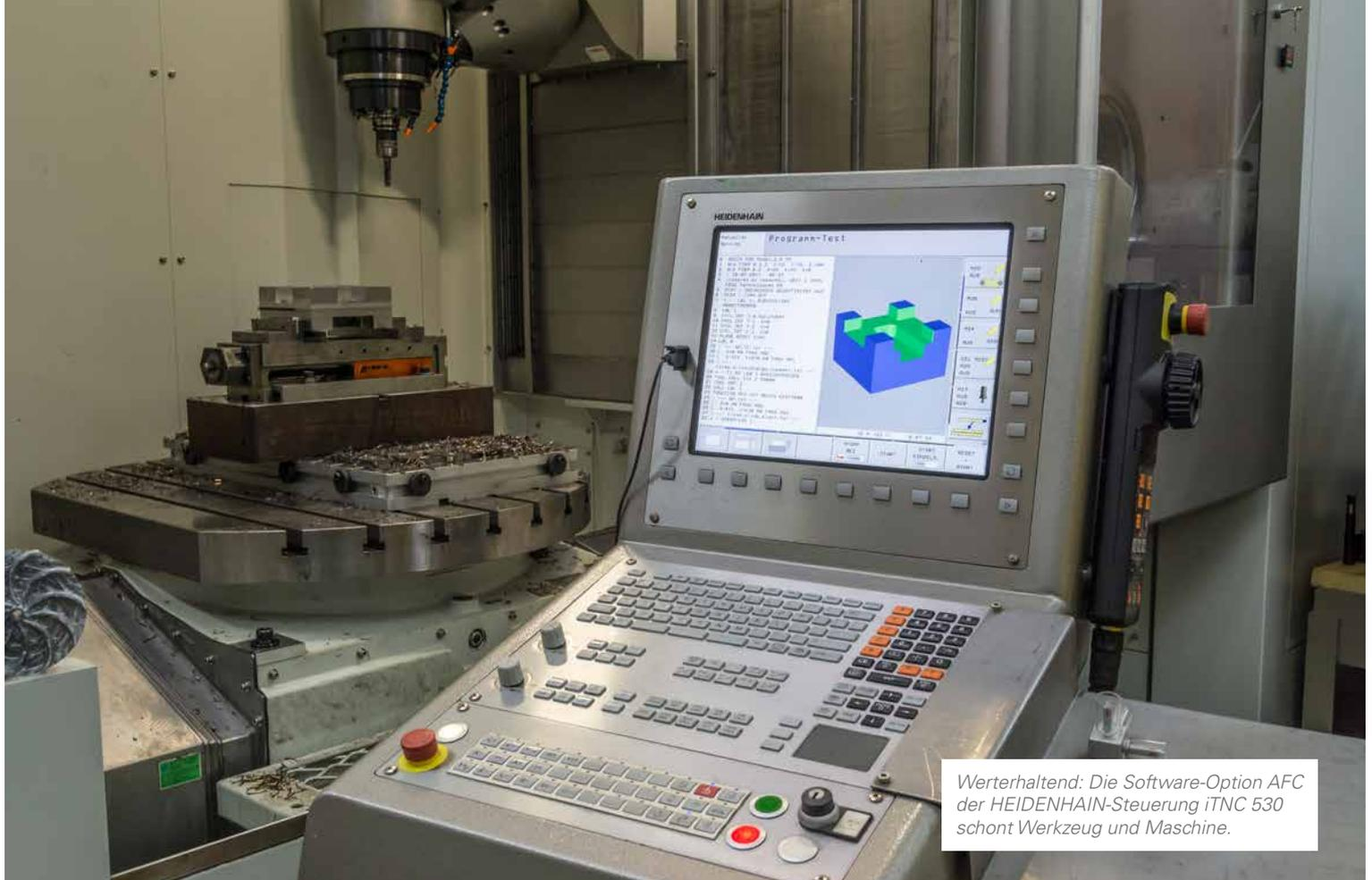
Werterhaltend: Die Software-Option AFC der HEIDENHAIN-Steuerung iTNC 530 schont Werkzeug und Maschine.
