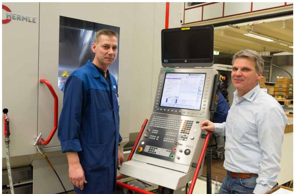
Maximale Effizienz auf kompakter Aufstellfläche: TNC-Anwender Ingo Kleis (li.) und Technischer Leiter Thomas Adler (re.) loben das stabile und genaue HERMLE C 12-Bearbeitungszentrum mit TNC 640-Steuerung.
