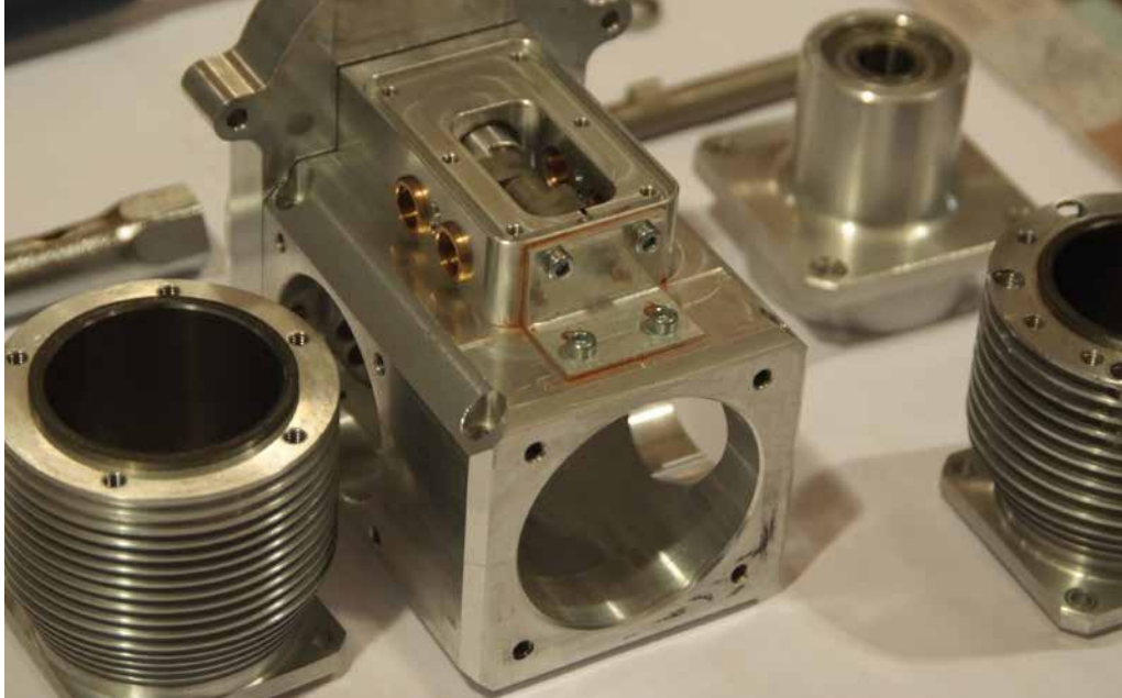
Komponenten eines Modellbau-Flugmotors gefertigt auf einer iTNC 530
