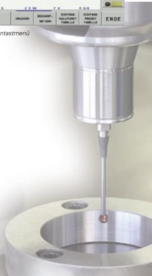
Bild 3: Antastzyklus mit Wertübergabe an die Preset-Tabelle
