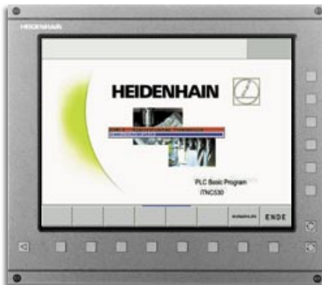
Die iTNC erkennt beim Hochfahren automatisch das angeschlossene Leistungsteil UM 121D der Y-Achse über das elektronische Typenschild
