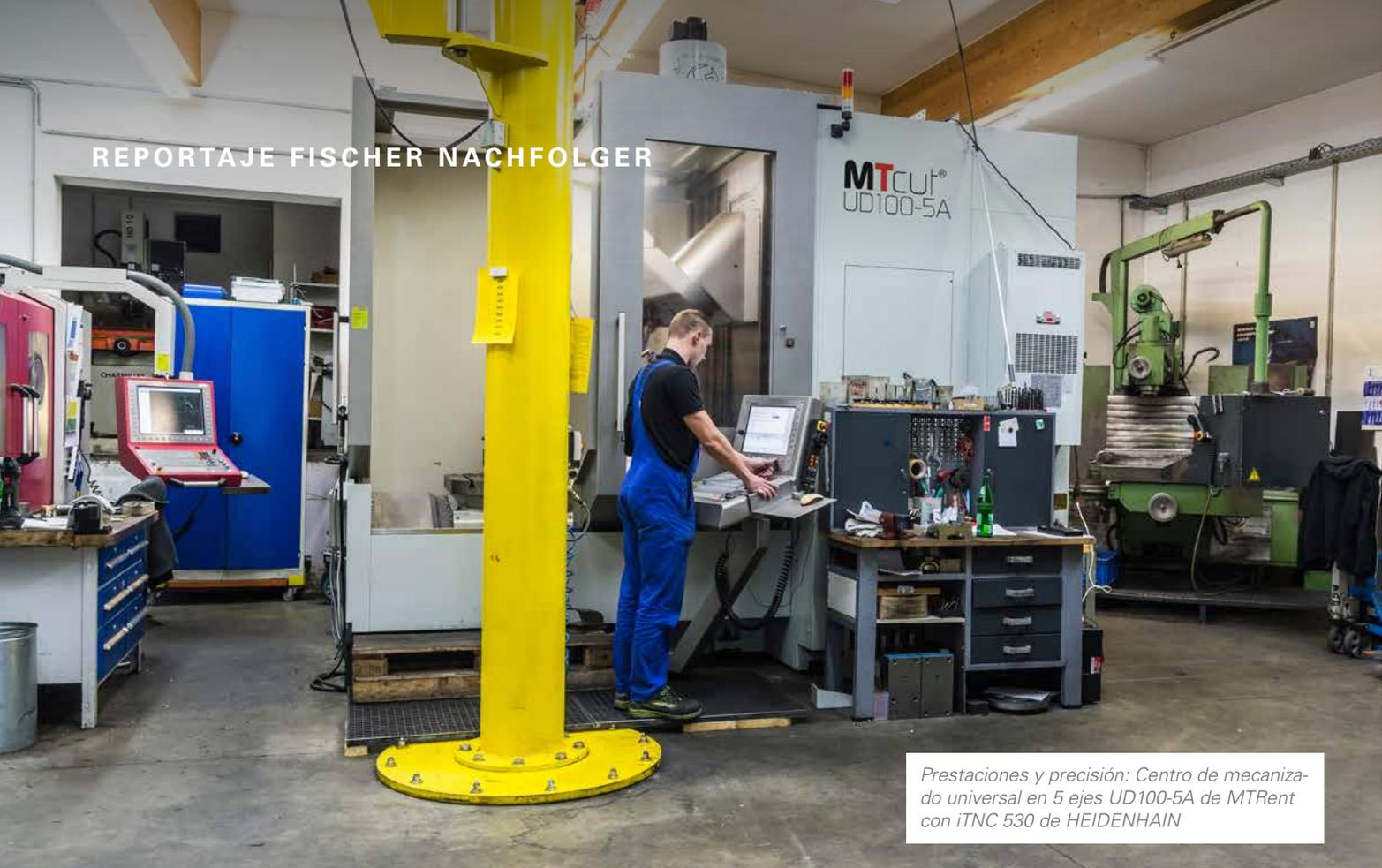
Prestaciones y precisión: Centro de mecanizado universal en 5 ejes UD100-5A de MTRent con iTNC 530 de HEIDENHAIN
