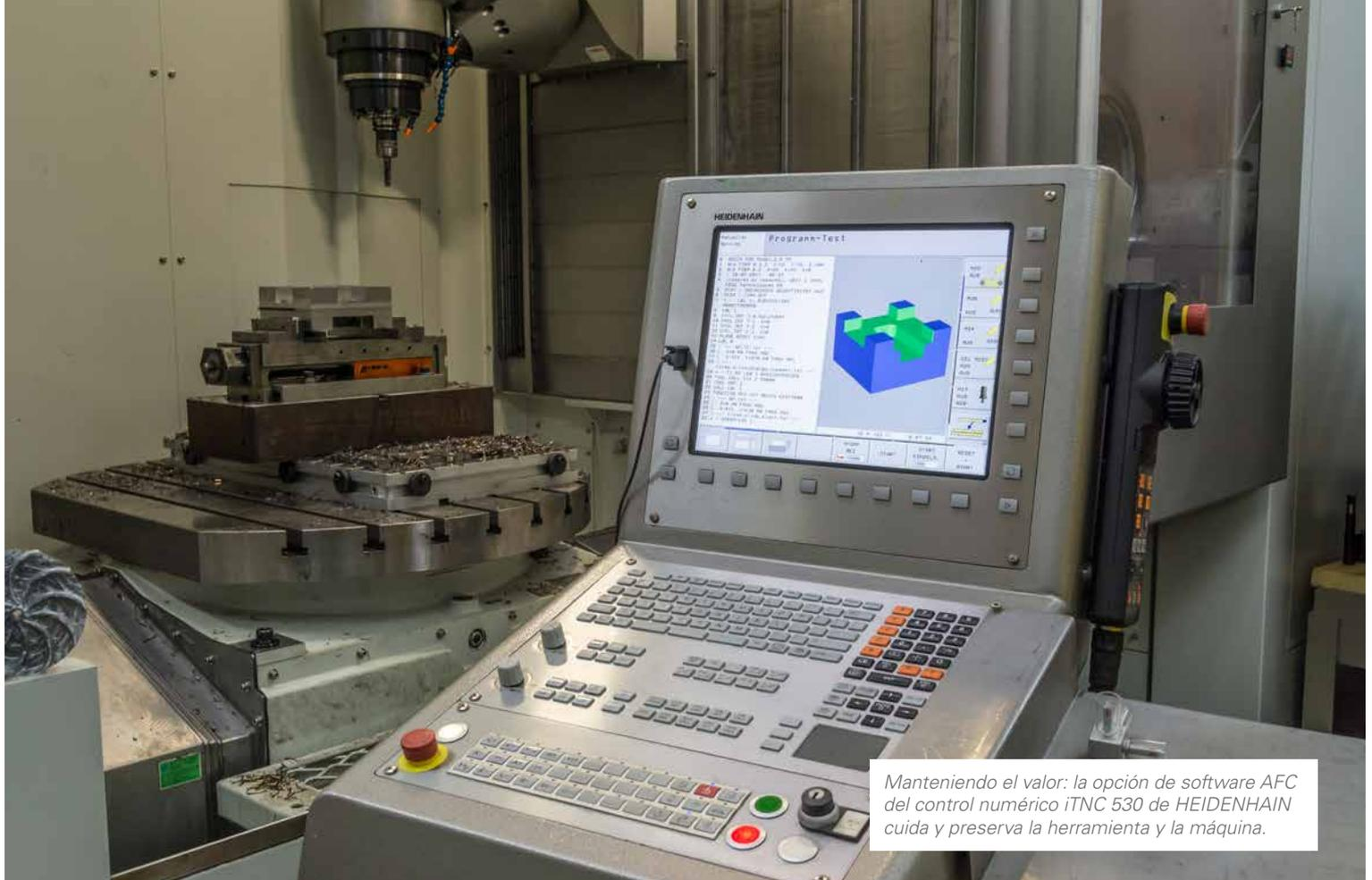
*Manteniendo el valor: la opción de software AFC del control numérico iTNC 530 de HEIDENHAIN cuida y preserva la herramienta y la máquina.*
