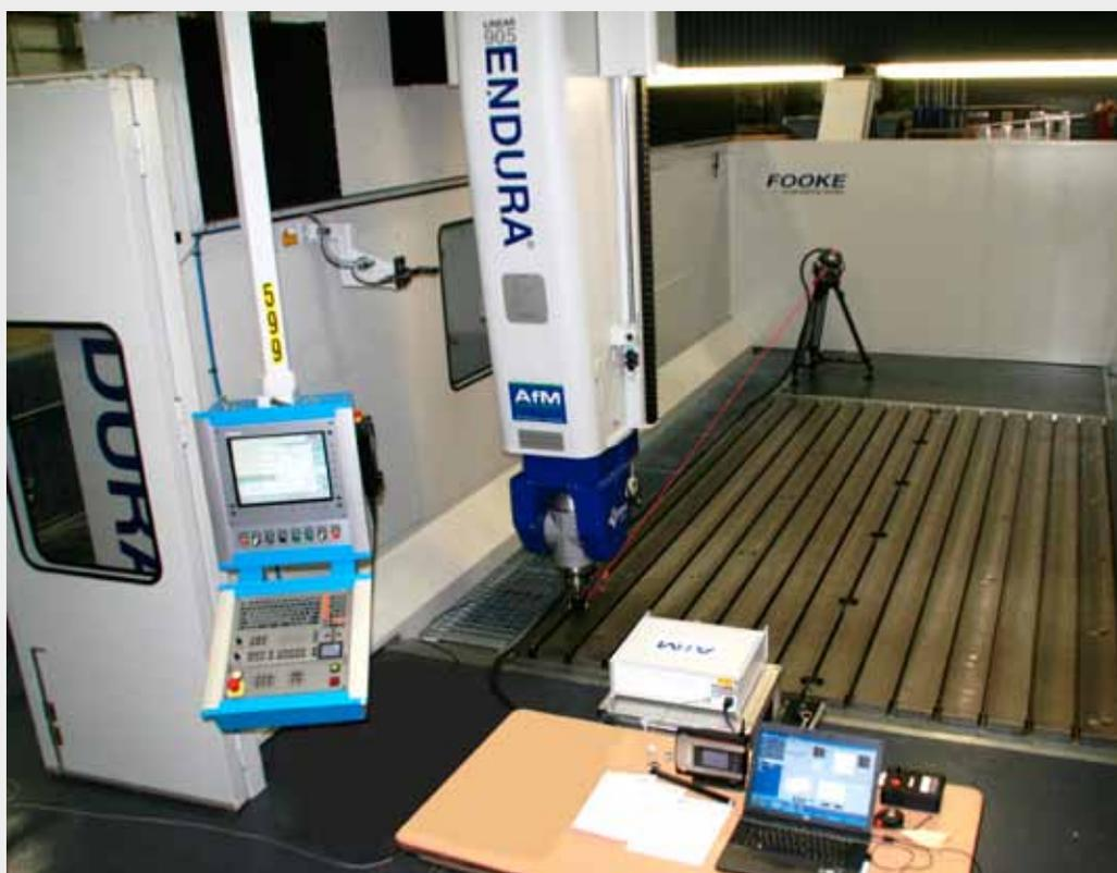
La máquina FOOKE ENDURA 905 Linear durante la calibración volumétrica
