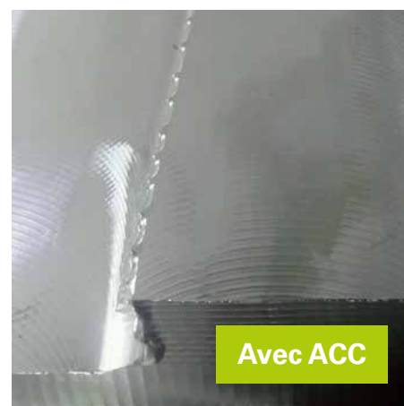
Résultat d'un usinage sur 7 mm avec la fonction ACC.
