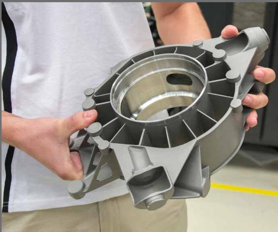
Un support de roue pour voitures de course usiné avec précision grâce à l'TNC 530 de HEIDENHAIN.
