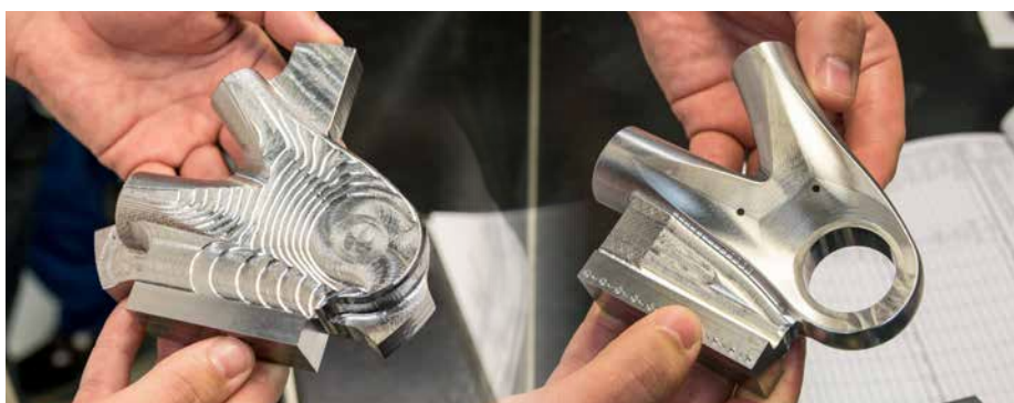
Une pièce parfaite obtenue en deux étapes : pièce de suspension d'une roue après l'ébauche (à gauche) et après la finition (à droite).
