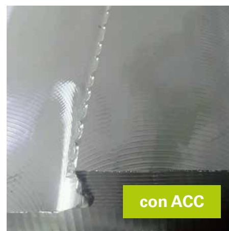
Risultato di una lavorazione con incremento di 7 mm con ACC.
