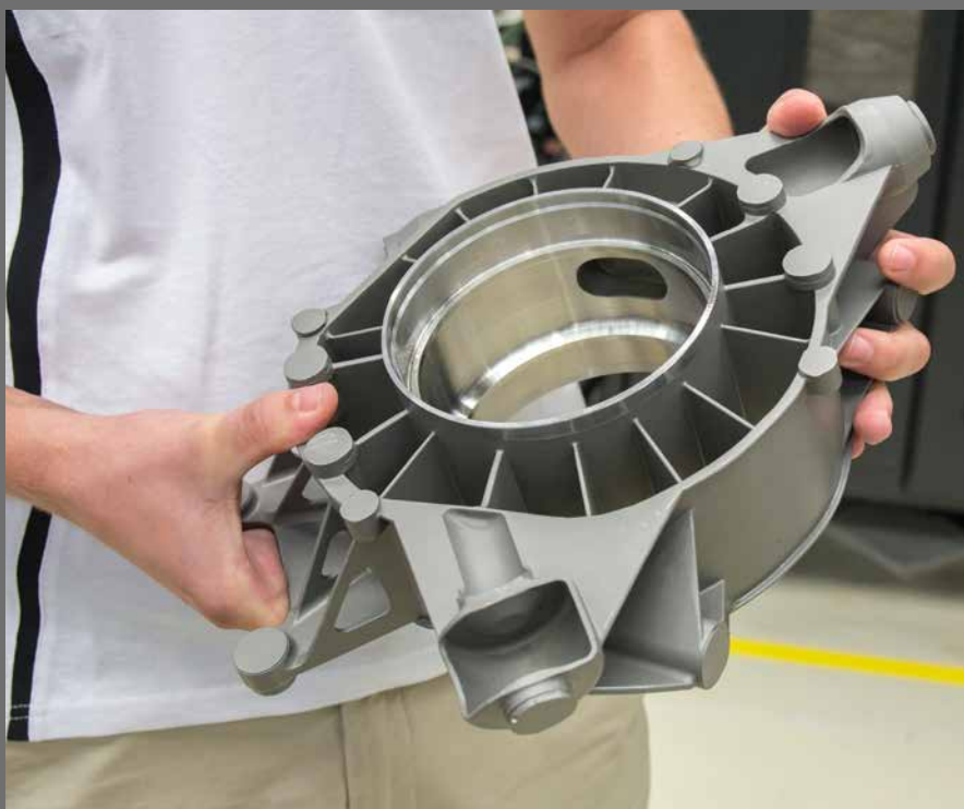
Montanti ruota per auto sportive: lavorazione precisa con il controllo numerico iTNC 530 HEIDENHAIN.
