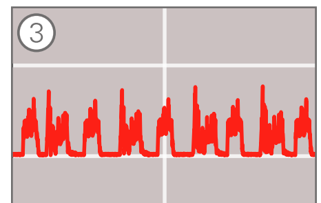
3 Dopo 58 minuti con AFC: potenza assorbita dal mandrino all'arresto della lavorazione da parte di AFC
