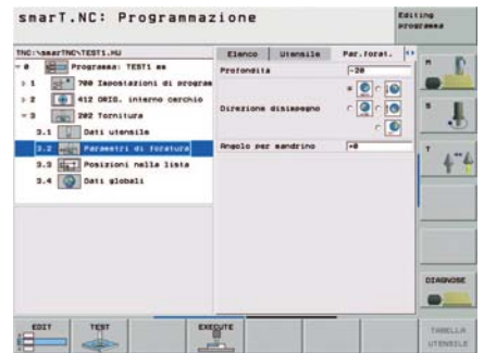
Figura 5: sottomaschera con opzioni di lavorazione supplementari
